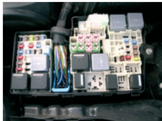
Skrzynka bezpieczników i przekładników samochodowej instalacji elektrycznej.
