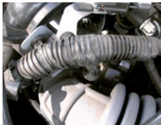
Wiązka przewodów instalacji elektrycznej.
