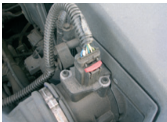
Połączenie zatraskowe wiązek instalacji elektrycznej.
